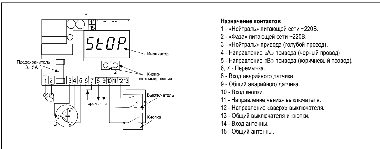
Рис. 74. Стандартная схема подключения P-5.5.
